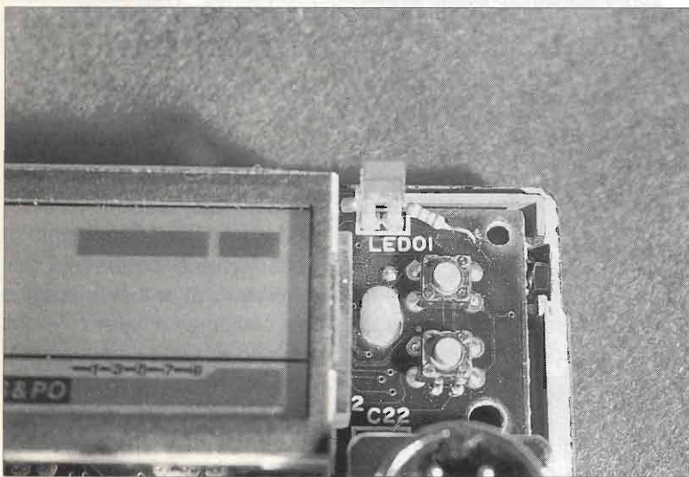
15 e 16 - Due differenti vedute dell'aspetto post operatorio del "doppio LED". Notare, in figura 16, il filo di collegamento relativo al catodo del LED aggiuntivo con l'annessa resistenza di limitazione della corrente.
